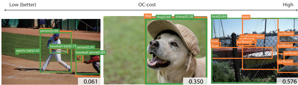
図2 VFNetによる物体検出結果とOC-cost。NMSはOC-costでチューニングしている。(オレンジ)真値アノテーション、(緑)検出結果。OC-costは画像の右下に表示している。
